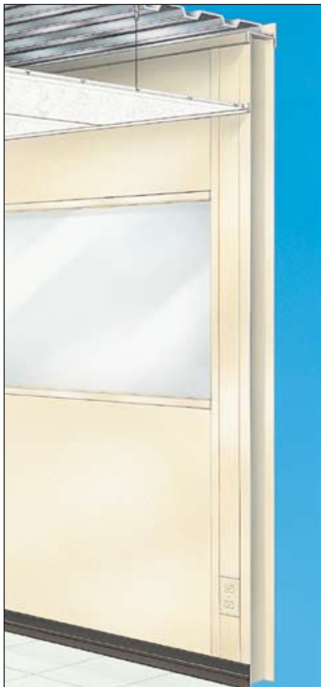
Techo suspendido desde la orilla del tejado.
